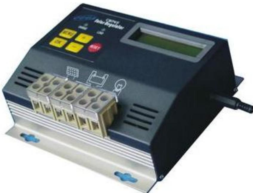
به طور اساسی، اکثر شارژ کنترلرها به سادگی ولتاژ باطری را بررسی و کنترل کرده و هنگامی که ولتاژ آن به سطح مشخصی رسید، مدار را باز کرده و عمل شارژ را متوقف می نمایند.
